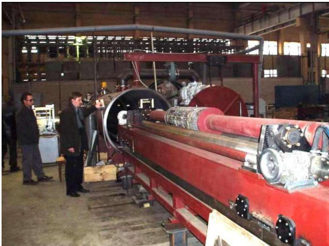
При столкновении ускоренного электронного потока с твёрдым телом 90% кинетической энергии электронов переходит в тепловую энергию.
