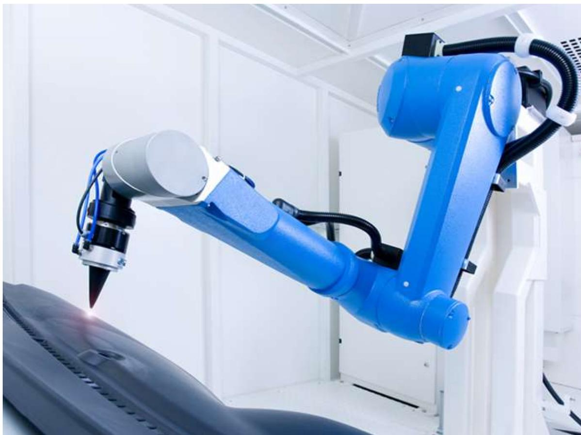
При попадании на поверхность световой луч частично поглощается ею и частично отражается от неё. Поглощение поверхностью энергии приводит к её нагреву, температура в точке приложения луча составляет от 2000 до 6000 С. Такая температура достаточна для расплавления и превращения в пар любого материала.
