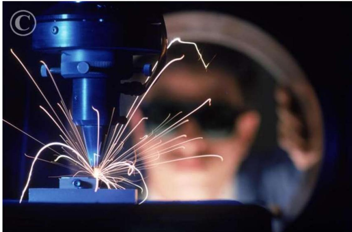
Большие плотности энергии обеспечиваются при небольшой мощности излучения за счёт фокусировки лучей на малой площади – около  $0,1 \text{ мм}^2$ . Поэтому лучевые методы обработки используют для вырезки высокоточных деталей, получения отверстий малого размера, разрезания труднообрабатываемых материалов, точной сварки, упрочнения и легирования поверхностей деталей.
