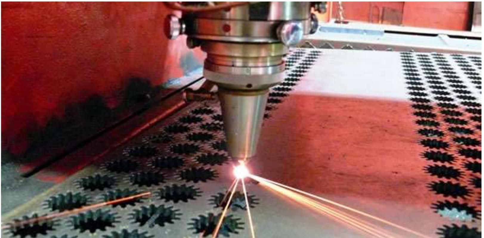
Температура тем больше, чем большей поглощающей и меньшей отражающей способностью обладает обрабатываемый материал, а также чем меньше его теплопроводность и теплоёмкость.
